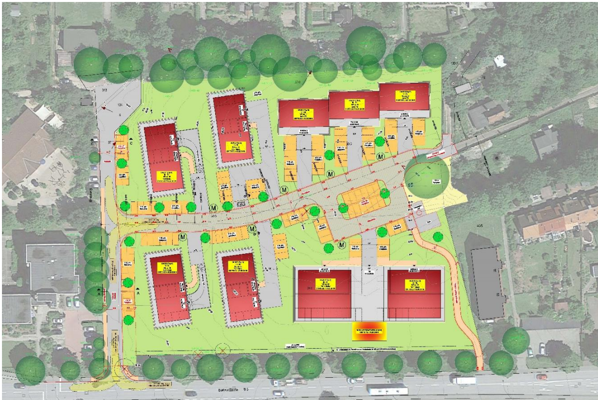
Abbildung 4: Erschließungsplan mit Darstellung des städtebaulichen Konzepts (ohne Maßstab), Stand 02.03.2021 (Quelle: Esling Ingenieurbüro). Das Konzept ist nicht verbindlich, es gelten die Festsetzungen aus dem B-Plan.
